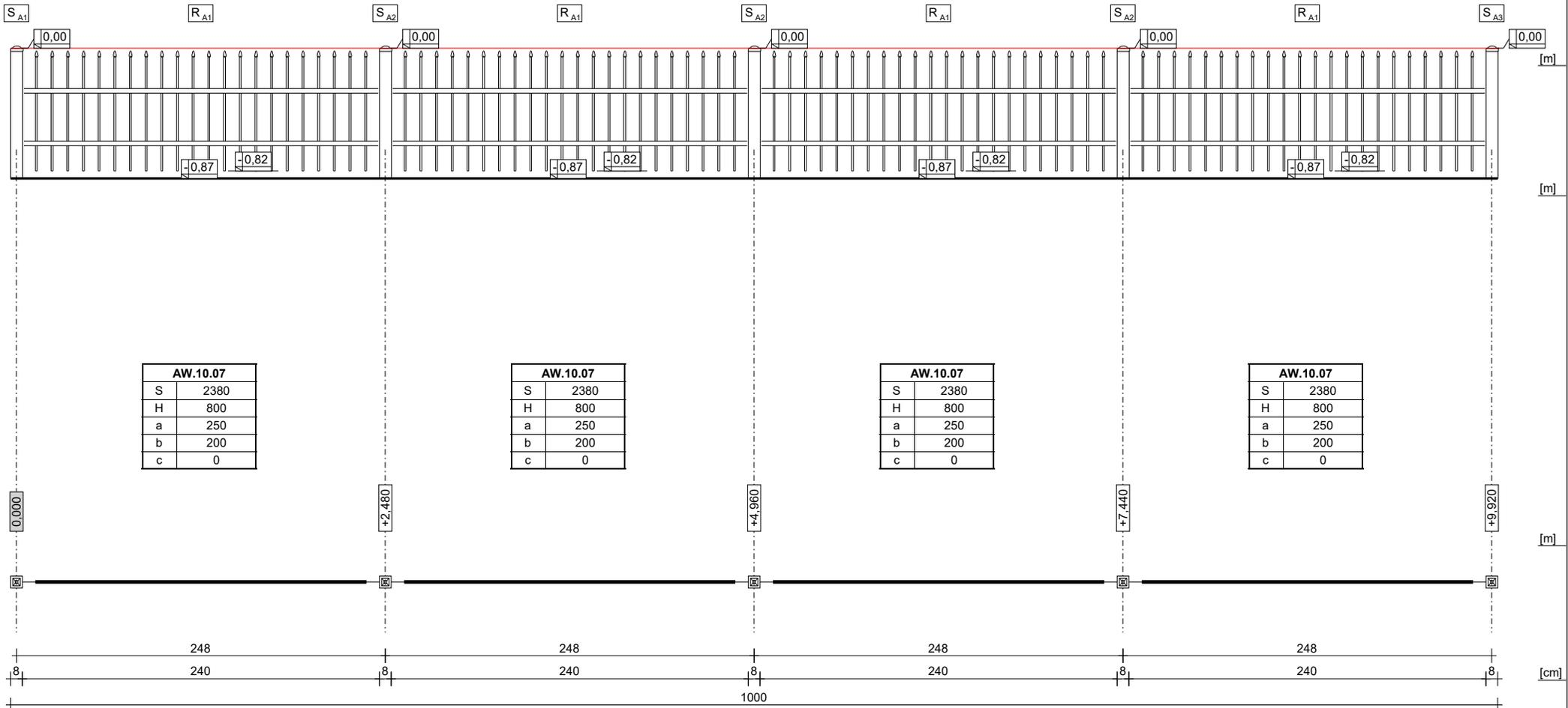
LEGENDE: S(So) - Elementbreite [mm]; H - Elementhöhe [mm]; a - Anordnung des oberen Querholms (für konvex und konkav zusammen mit dem Bogen gerechnet) [mm]; b - Anordnung des unteren Querholms [mm]; c - Bogenhöhe [mm]
